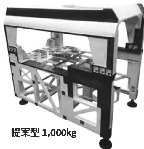
図4 トポロジー最適化による鋳物フレームの軽量化
