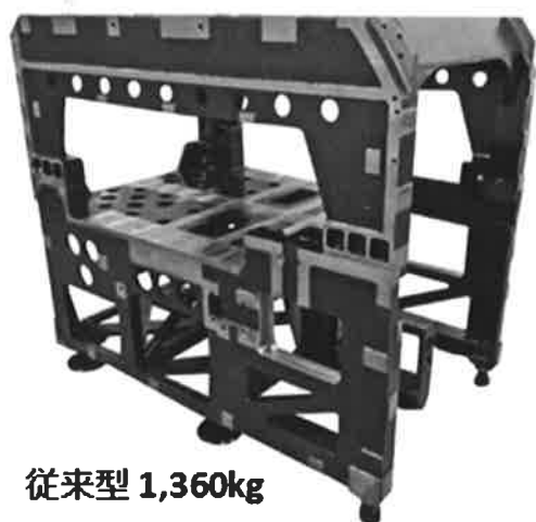
図4 トポロジー最適化による鋳物フレームの軽量化
